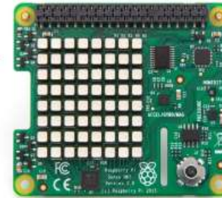
SenseHat 10 DOF szenzor 3 tengelyű gyorsulásmérő 3 tengelyű magnetométer 3 tengelyű giroszkóp barométer + hőmérő Funkció: Dead reckoning helymeghatározás, barométeres magasságmérés
