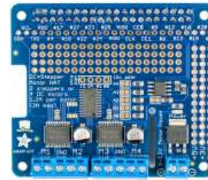
Adafruit DC & Stepper Motor HAT motorvezérlő 4 darab egyenáramú vagy 2 darab léptető motor vezérlése Funkció: platform vezérlése
