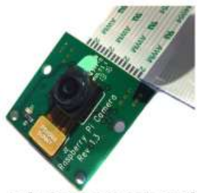
Pi Camera Board színes kamera 5 MB Funkció: álló és mozgóképek rögzítése
