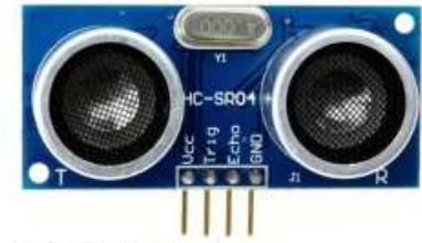
HC-SR04 ultrahangos távmérő 4 méteres hatótáv Funkció: akadály érzékelés
