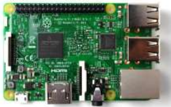
Raspberry Pi 3 számítógép Funkció: szenzorok vezérlése, adattárolás, hálózati kommunikáció
