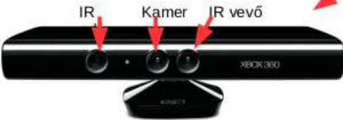
Kinect mélységkamera 40 méteres hatótáv Funkció: 3D pontfelhő
