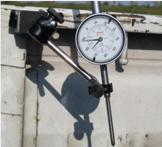
Mérőóra 0,01 mm leolvasást biztosító pontossággal.
